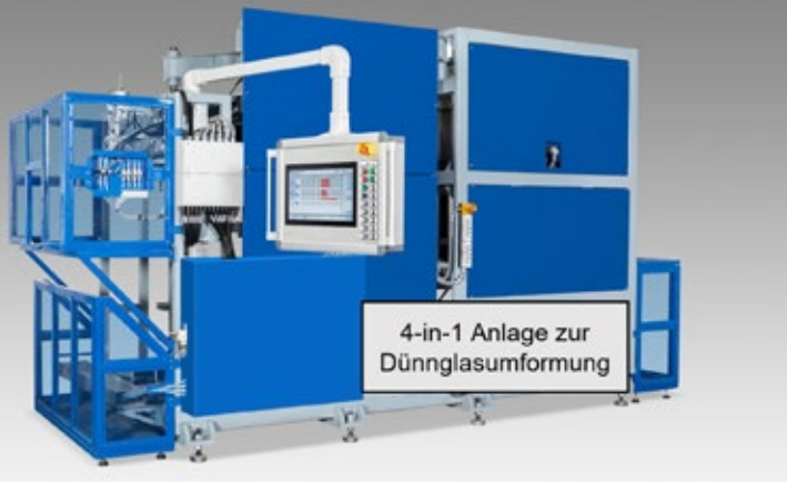
Abbildung 2: 4-in-1 Anlage zur Dünnglasumformung der Firma Vitrum Technologies ©Vitrum Technologies GmbH
