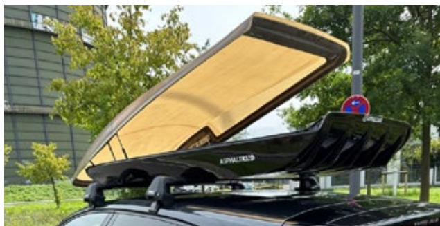
Einsatz von Cellulosefaser-Gewebe bei der Oberschale © Cropfiber GmbH
